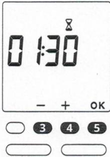
Stellen Sie die gewünschte Zeitdauer (von 30 Minuten bis 72 Stunden) mit der Taste „+“ **4** oder „-“ **3** ein (z.B. 1h30) und bestätigen Sie mit „OK“ **5**.
