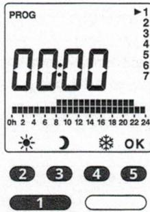
An dem Strichdiagramm lässt sich in der oberen Reihe die Programmierung der Komfort-Zeiten ablesen und an der unteren Reihe die Zeiten der Eco-Programmierung.
